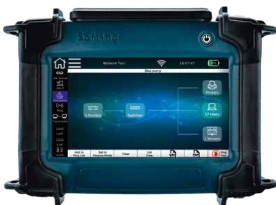
对于网络发现测试，只需将主机连接到交换机即可。
